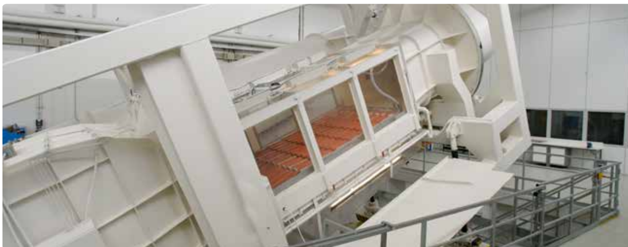
Bij Monier testen we onze dakpannen uitgebreid, onder andere in de wind- en regentunnel.
