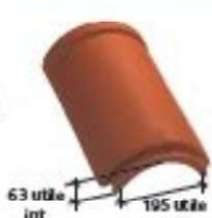
Faîtière/arête 1/2 ronde à emboîtement grand modèle (2,5 au nt) Réf. 702 Crochet adapté : crochet F1 - Réf. CRP 702
