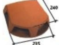
Lanterne bi-section Ø 150 utile et Ø 120 utile. Section d'aération : 130 cm 2 Réf. 1000
