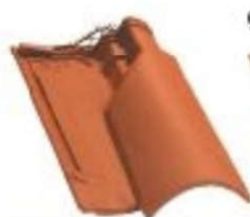
Tuile de ventilation Oméga 10 (section avec grille = 33 cm 2 ) Réf. 104.20
